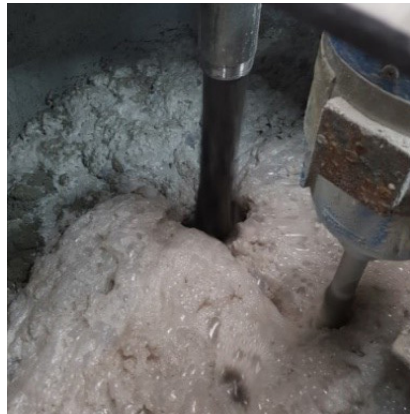
über eine 25% w-Slurry (stark thixotropiert = hocheffizient, vereinfachtes Handling)
