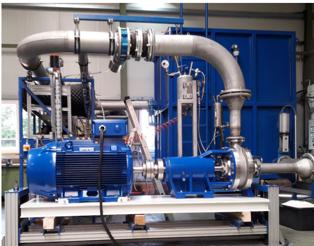
GORAMILL ® 33, 160 kW auf dem Prüfstand: Entwicklung und Analysen – ein Muss
